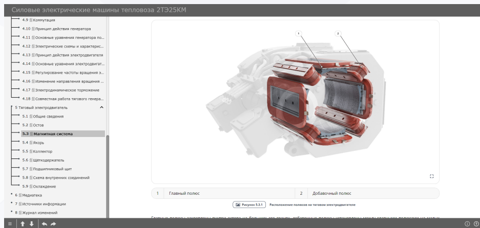
Расположение полюсов на тяговом электродвигателе
