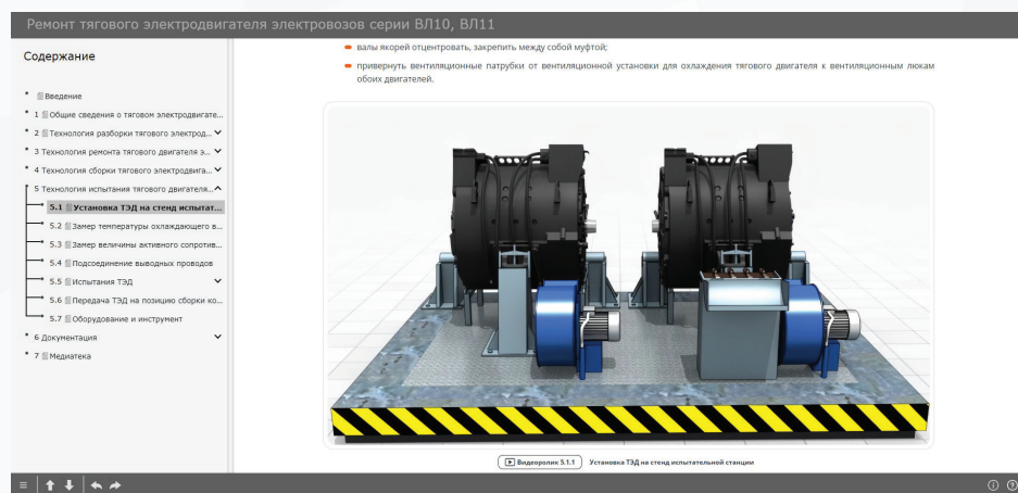
Установка ТЭД на стенд испытательной станции
