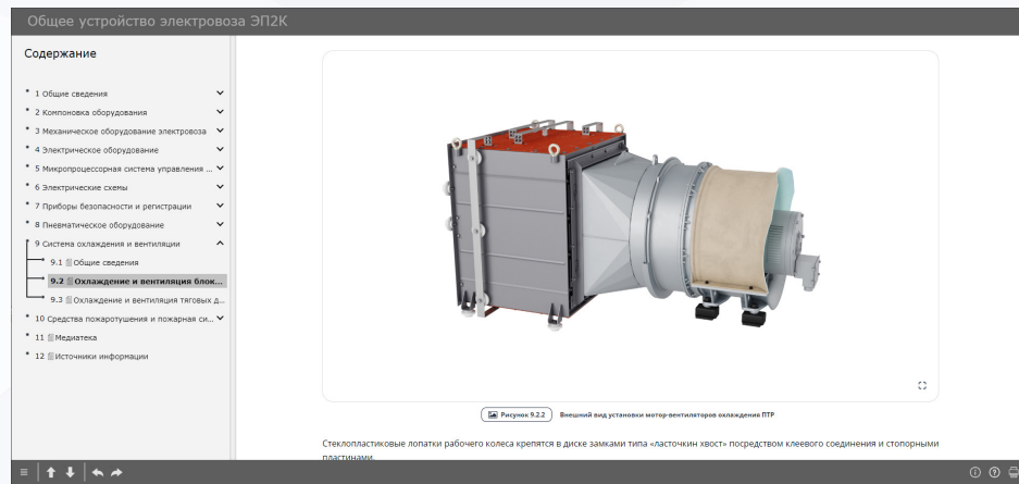
Внешний вид установки мотор-вентиляторов охлаждения ПТР
