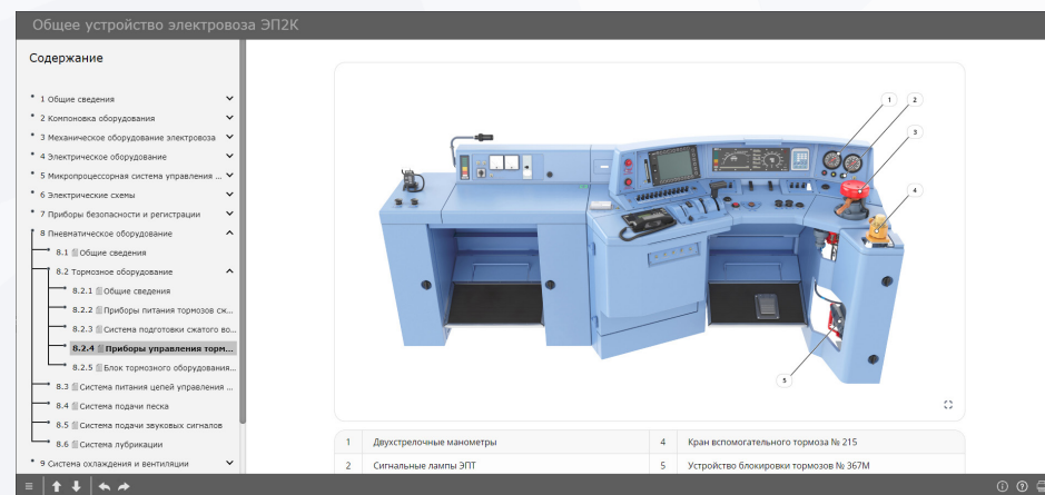
Расположение приборов управления тормозами на пульте
