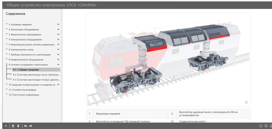
Система вентиляции ТЭД и кузова одной секции
