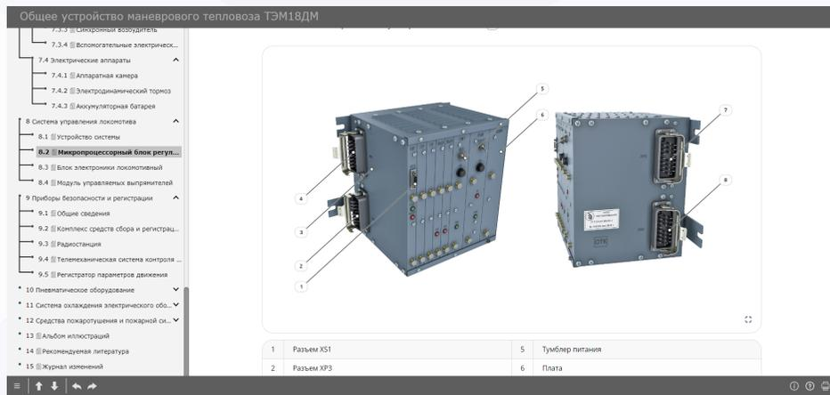
Устройство микропроцессорного блока регулирования
