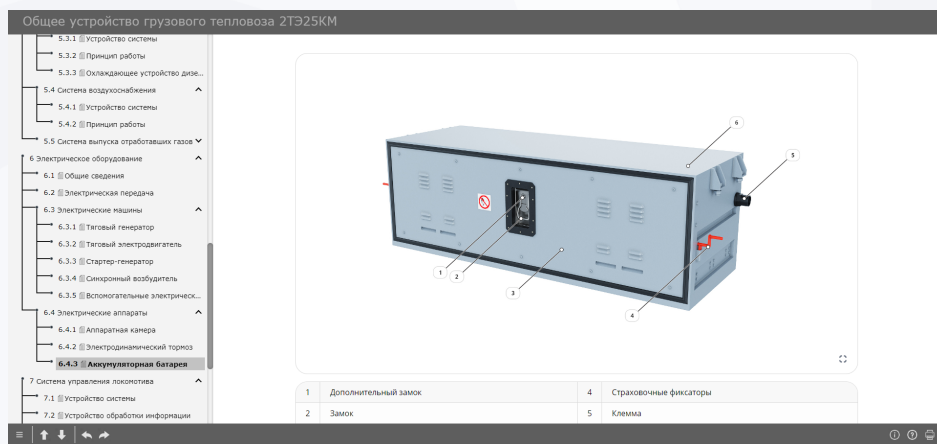
Устройство аккумуляторного бокса
